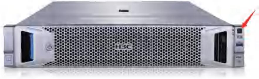
图 2-3-2-1 打开服务器电源开关
