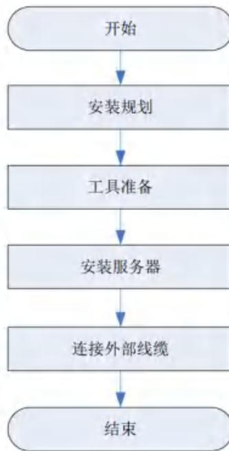
图 2-2-2-3 安装流程图
