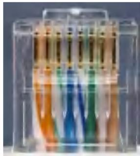
图 1-2-2-8 将线缆插入水晶头
